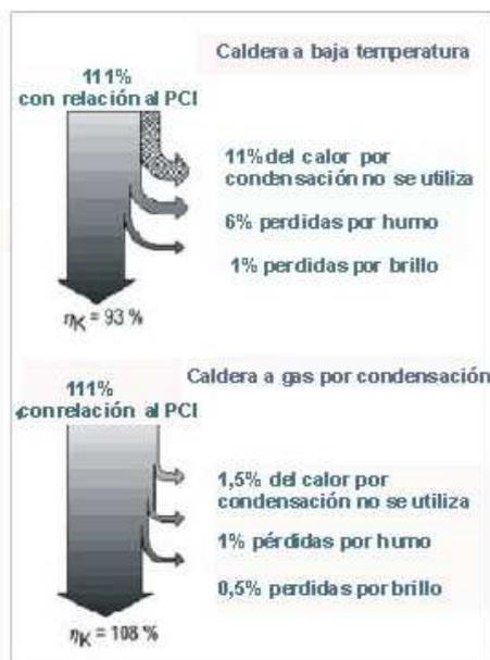
Figura 2.- Comparación de calderas de baja temperatura y de condensación
