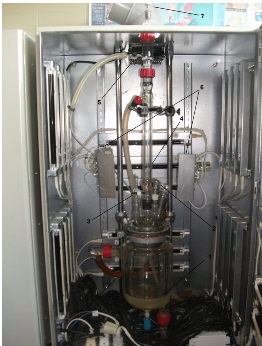
Figura 4.1. Dispositivo experimental para estudiar las emisiones evaporativas.
