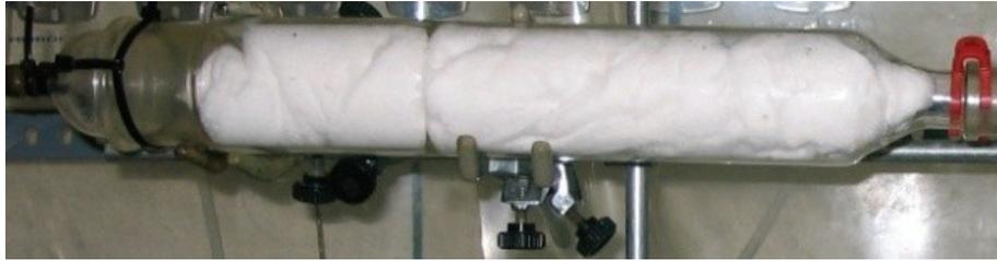
Figura II.5. Filtro de algodón utilizado en los experimentos de torrefacción.
