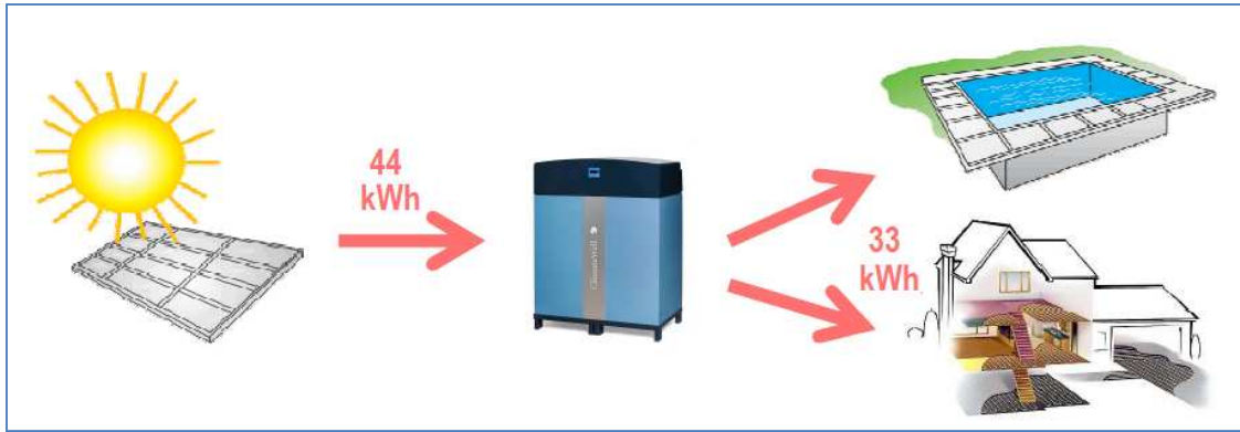
Figura 7: Proceso de carga. (ClimateWell_10 producto.pdf)
