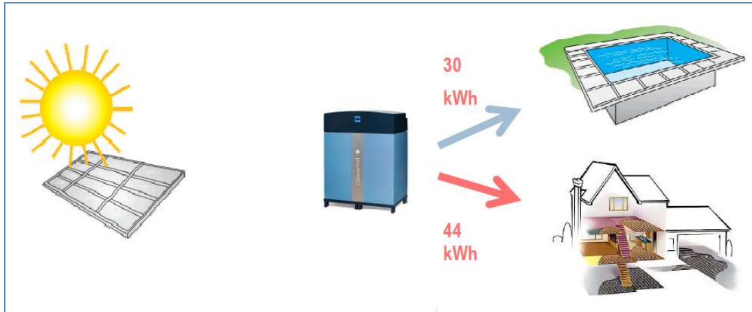
Figura 12: Balance de energía durante el calentamiento. ( ClimateWell_10 producto.pdf )
