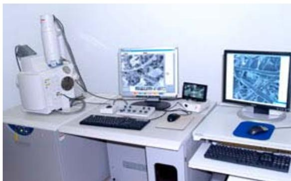
Figura 3.3 Equipo de microscopía electrónica de barrido y energía dispersiva de rayos X.
