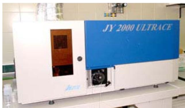
Figura 3.4 Equipo de espectroscopía de emisión óptica mediante plasma de acoplamiento inductivo (ICP-OES).
