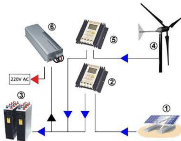
Ilustración 4. Esquema instalación fotovoltaica a red aislada híbrida
