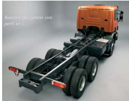
Figura 2: Bastidor de camión con perfiles en U.
