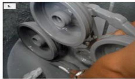
b) Recubrimiento con pintura refractaria
