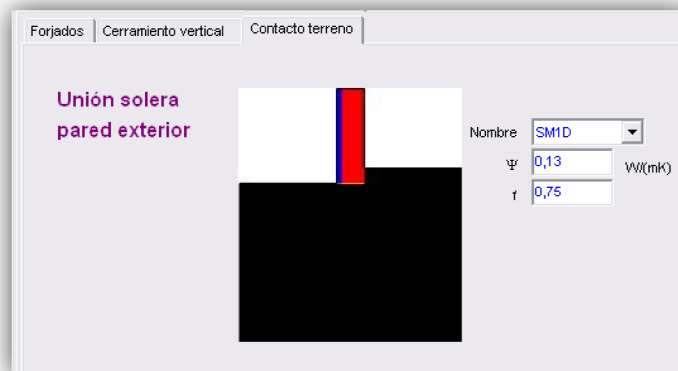
Imagen 8.1.3. Puentes térmicos en contacto con el terreno.
