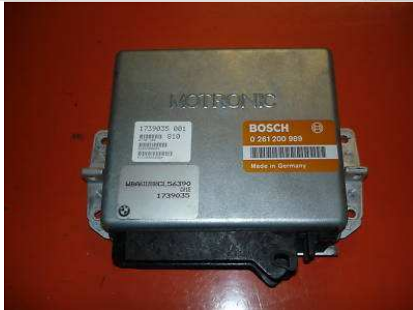
Figura 5: ECU de control del sistema de control de motor MOTRONIC, de la marca BOSCH
