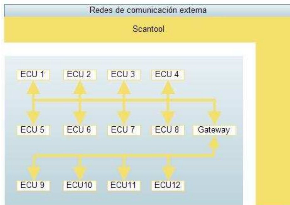
Figura 38: Ejemplo de sistemas de comunicación entre los ECUs del vehículo y el exterior.
