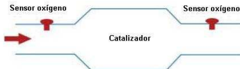
Figura 33 : Sensores situados en torno al catalizador para analizar su funcionamiento.
