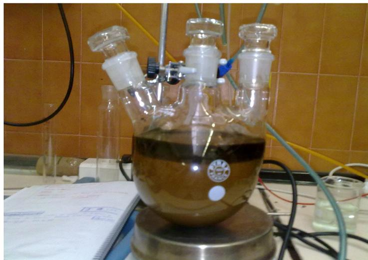
Figura 4.3. Lejía negra al terminar la reacción de desilicación, en la que se observa el precipitado de color claro.
