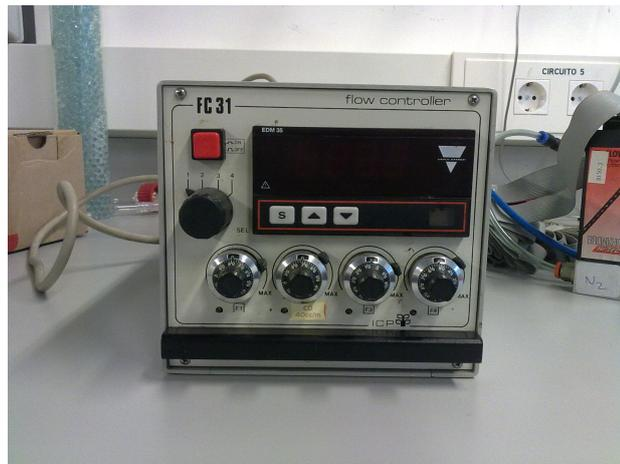
**Figura II.1. Controlador FC31 utilizado, en el que se aprecian la pantalla de lectura y las 4 ruletas pertenecientes a los distintos canales.**
