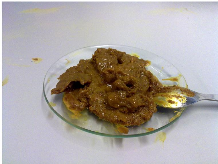
**Figura 4.5.** Detalle de los sólidos precipitados, tras separarlos del líquido y antes de secar.
