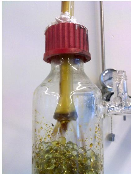
Figura 3.6. Detalle del sistema de alimentación del líquido en el reactor, en forma de ducha.
