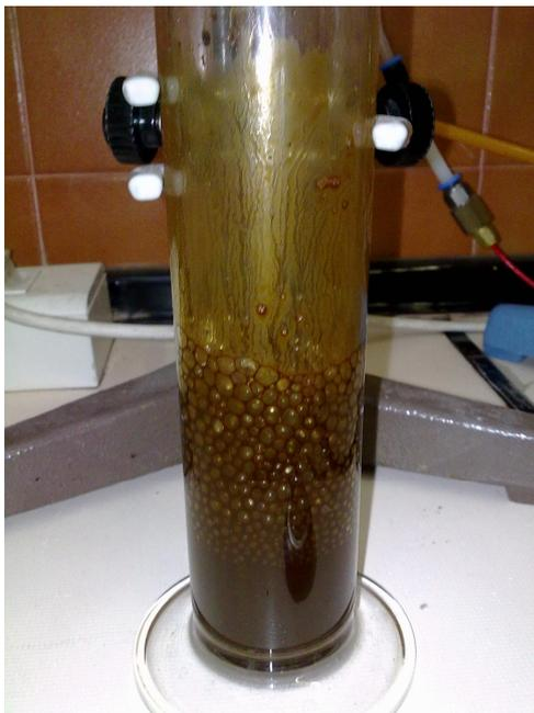
Figura 4.1. Formación de espumas en el Reactor de Borboteo
