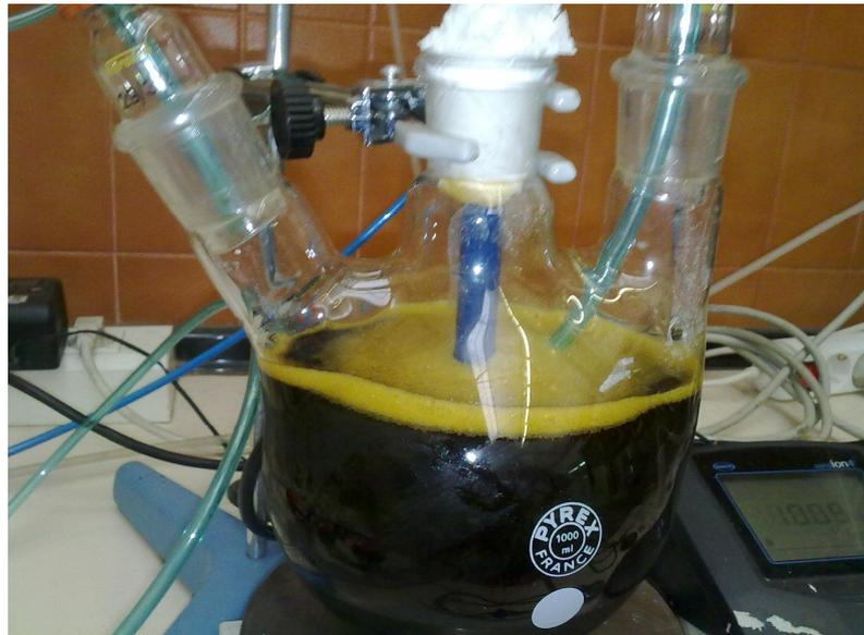
Figura 4.2. Detalle de la mínima formación de espumas durante la reacción.
