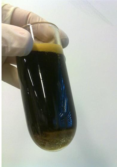
**Figura 4.28. Detalle del precipitado formado tras centrifugar las muestras desilicadas con el reactivo líquido de SPECCEL.**
