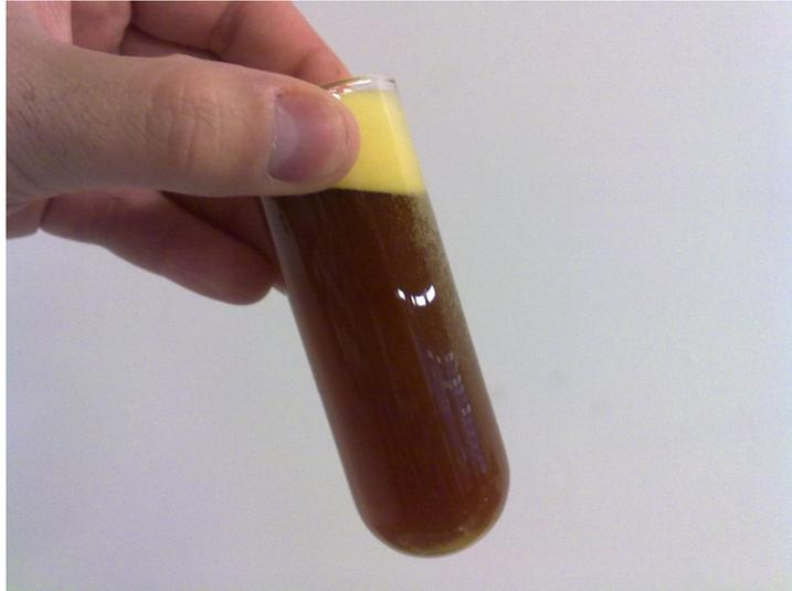
Figura 4.29. Detalle de la turbidez de la lejía obtenida en el experimento BSTR\_SPECEL\_3, en la que no se aprecia separación del sólido tras centrifugar.
