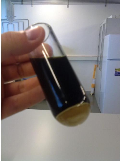
**Figura 4.4.** Detalle de la probeta tras centrifugar, en la que se aprecia el sólido compacto, y el líquido, de color oscuro.
