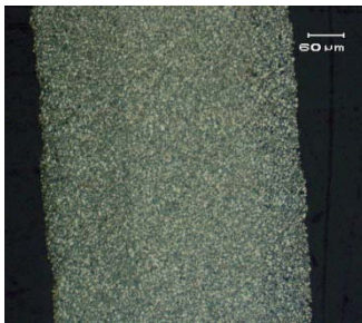
Foto 10: Muestra comprimida al 50%.
