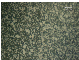
Foto 13: Muestra comprimida al 50%. Unión entre láminas de distinta composición.
