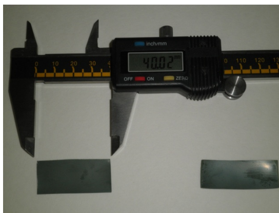
Foto 5: Anodos sinterizados, listos para ser sometidos al tratamiento en atmósfera reductora.
