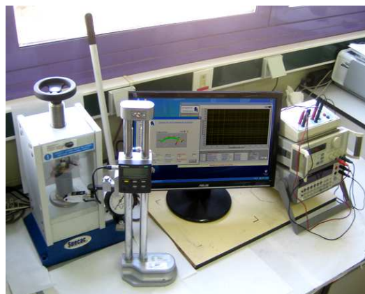
Figura 2.2. Esquema [15] y equipo experimental de medida de conductividad eléctrica.
