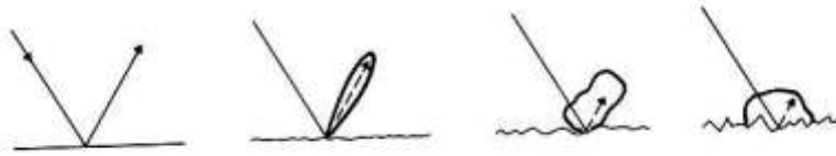
Fig. 4 Formas de retro-dispersión en función de la rugosidad del terreno. Fuente: Canada Centre for Remote Sensing ( http://ccrs.nrcan.gc.ca/resource/index_e.php ).
