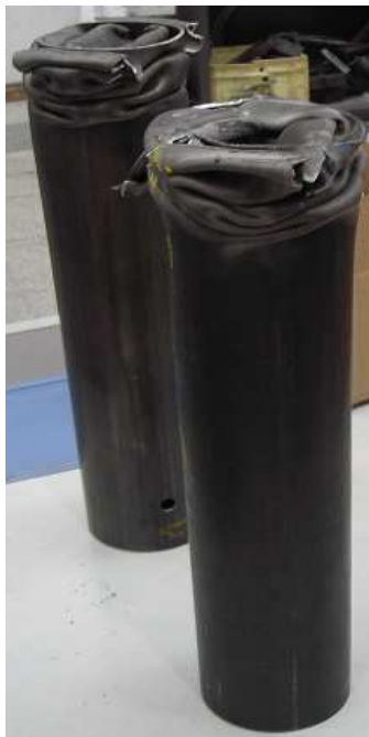
Imagen 1.3 Tubos tras el ensayo en la Instron
