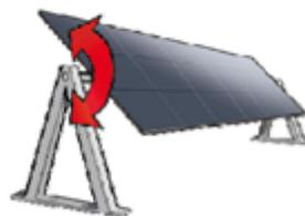
Fig. 3.2: Movimiento de un seguidor de un eje polar.
