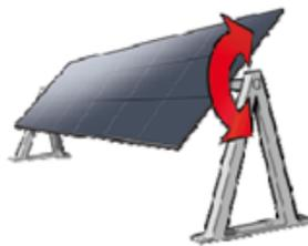
Fig. 3.3: Movimiento de un eje este-oeste horizontal.
