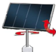
Fig. 3.1: Movimiento de un seguidor de dos ejes.
