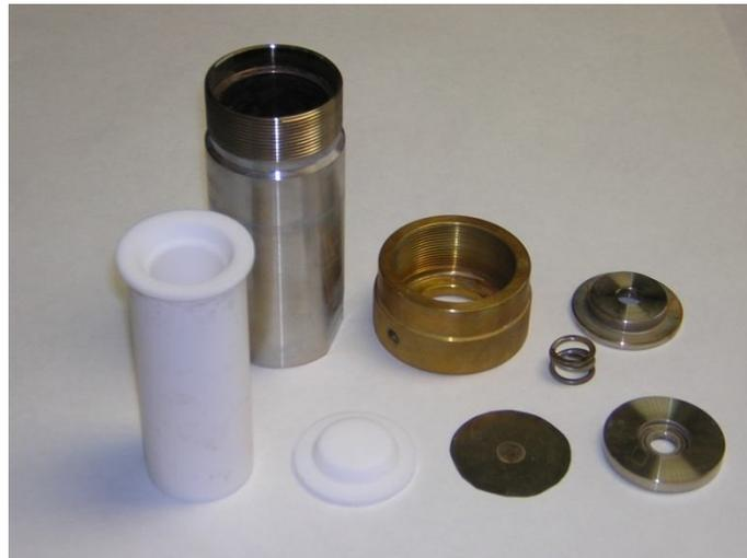
**Figura 7.** – Componentes de una autoclave de 43 cm<sup>3</sup>.
