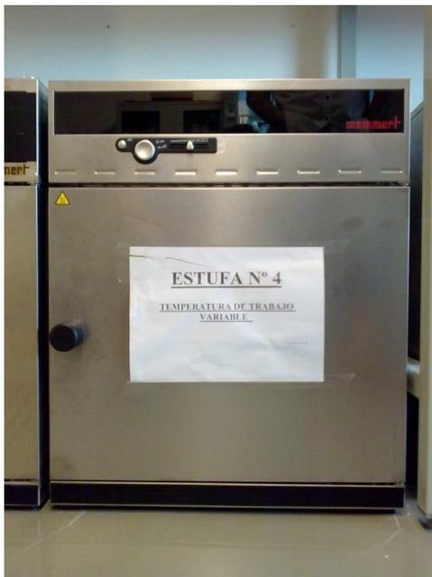
**Figura 8.** – Estufa empleada en la síntesis de zeolitas.
