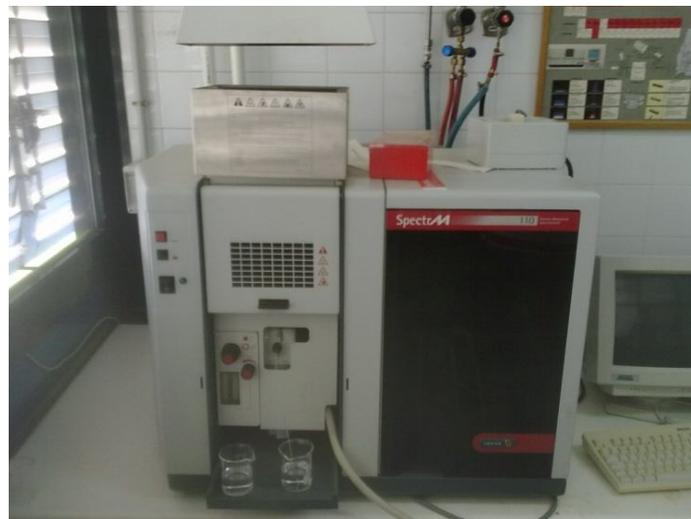
**Figura 12.-** Equipo utilizado en este trabajo para realizar las medidas de adsorción atómica.
