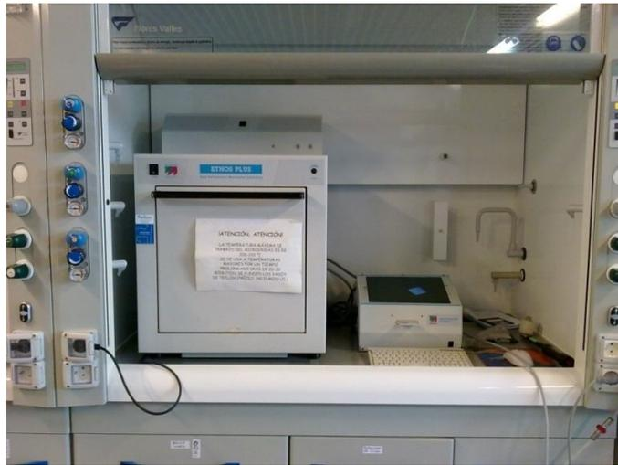
**Figura 11.-** Equipo microondas empleado en la disolución de muestras.
