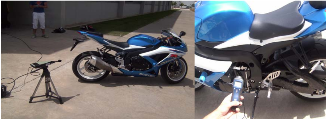
Foto 7. Sonómetro y tacómetro durante el ensayo de medición.
