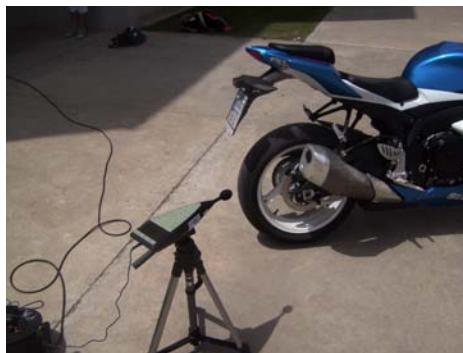
Foto 6. Sonómetro durante el ensayo de medición de la motocicleta.
