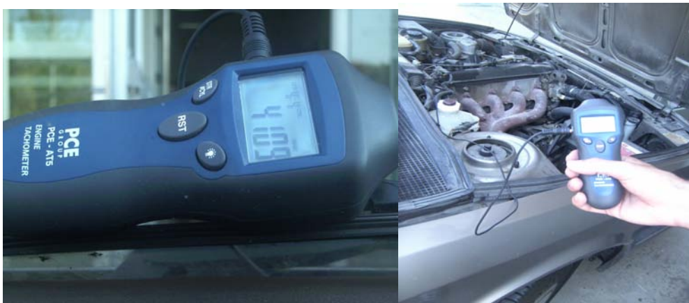
Foto 3 y 4. En la primera foto el tacómetro nos muestra las rpm y en la segunda vemos que está conectado al cable de la bujía.
