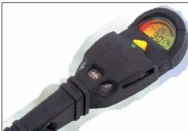
**Fig.118. Manómetro de control de la presión.**
