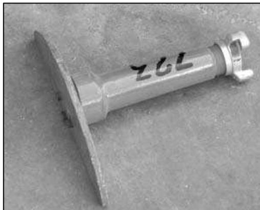
**Fig.156. Lanza formadora de cortina.**
