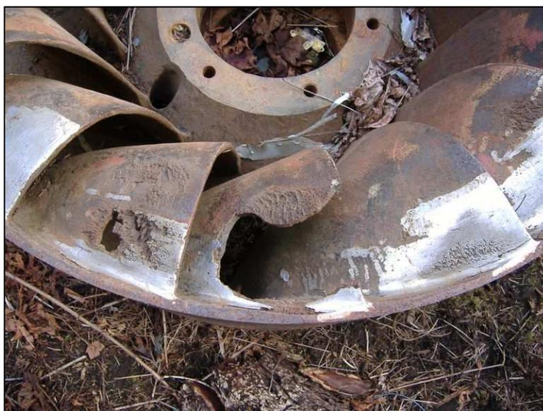
**Fig.39. Daño por cavitación de una turbina Francis.**
