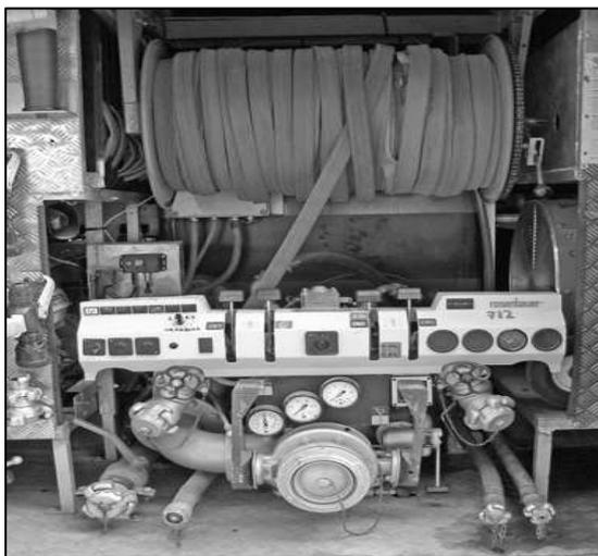
**Fig.148. Bomba centrífuga.**
