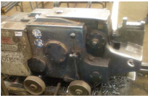
Cizalla no adaptada al RD 1215/1997
