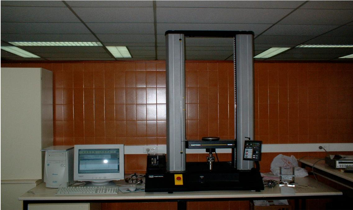
Esta máquina dispone de varios accesorios. Dependiendo del tipo de ensayo que se quiera realizar, se utilizará un accesorio u otro. De este modo, se pueden realizar, entre otros, ensayos de flexión, de tracción y de compresión.
