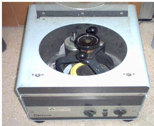
En el molino de bolas se introdujo la mezcla de las diferentes sustancias en polvo, para realizar una mezcla compacta. El recipiente que se usó para introducir la mezcla en la moledora es de ágata con bolas del mismo material.
