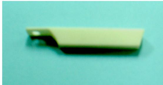
Se trata de una navecilla de alúmina. Se utilizó para colocar las muestras de fibras en el interior del horno para realizar los tratamientos térmicos. Esta fabricado de un material cerámico que aguanta elevadas temperaturas. Pero es poco resistente al choque térmico.
