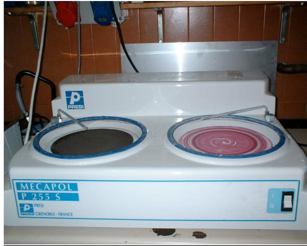
La lijadora se ha utilizado para desbastar las barras y así poder obtener un superficie longitudinal de las muestras para observarlas en el microscopio óptico.
