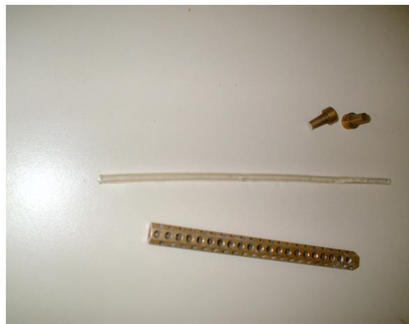
Tubo de látex en el que se introduce la mezcla para meterla en la prensa isostática. Se utilizó el tubo de agujeros para poder introducir el tubo de látex en la prensa y que el prensado fuera homogéneo. Los tapones se colocan en lo extremos del tubo de látex para cerrarlo mediante bridas de plástico y teflón, con el fin de impedir que penetre el agua de la prensa en el interior del tubo durante el prensado.
