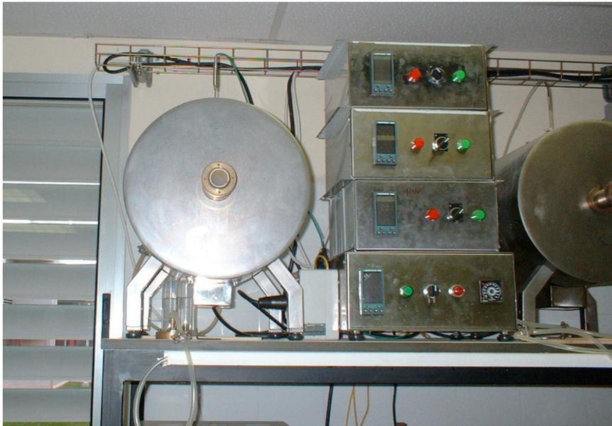
Este horno se utilizó para realizar los tratamientos térmicos. Tiene un dispositivo que permite programar la temperatura máxima a alcanzar, así como el tiempo que queremos emplear en alcanzar dicha temperatura.
