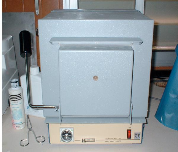
En el horno se realizaron los primeros tratamientos térmicos para el conformado de las muestras, antes de tratarlas en el láser.
