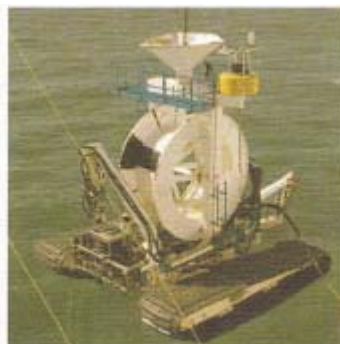
Fig. 6. 16 Vehículo de operación remota de soterramiento de cables en el fondo
