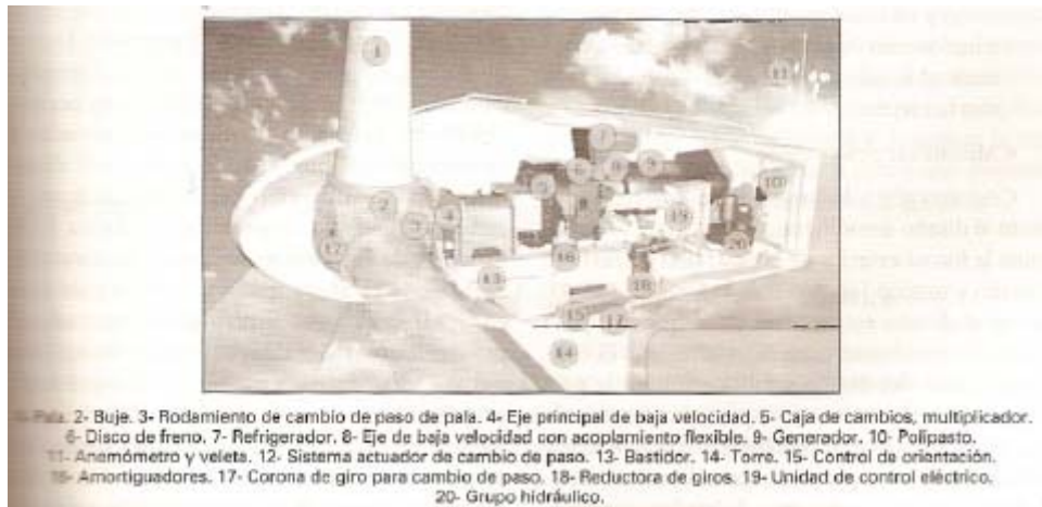
Fig. 3. 8 Góndola con los elementos más significativos. Modelo de GAMESA
