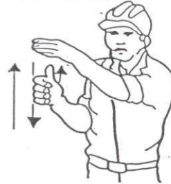
4 Levantar el aguilón o pluma lentamente
