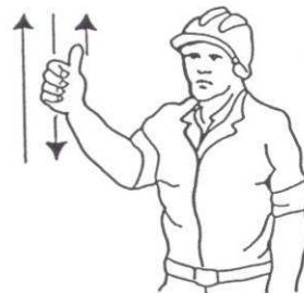
4 Levantar el aguilón o pluma lentamente
