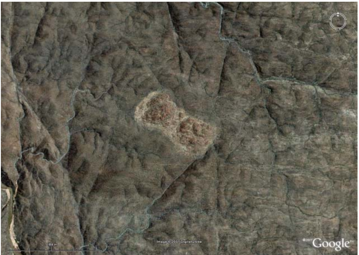
Figura 3.1.75. Imagen de satélite de un stock de granodioritas hacia el sur de la zona estudiada (nótese que corta la foliación, y su forma elipsoidal).
