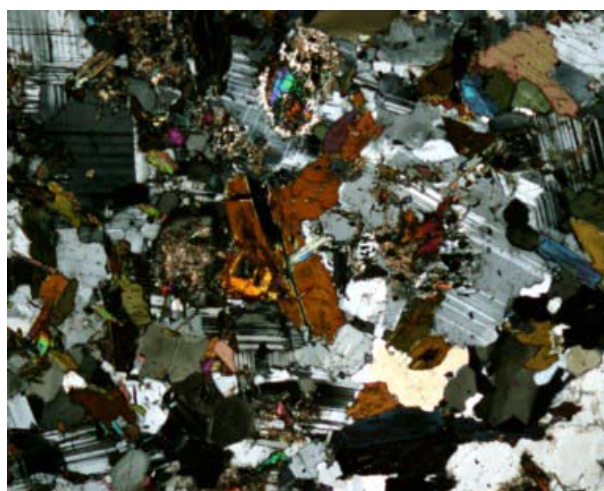
Figura 3.1.57. Detalle al microscopio de luz transmitida (en nícoles cruzados) de la muestra anterior; nótese la zonación del cristal de allanita.
