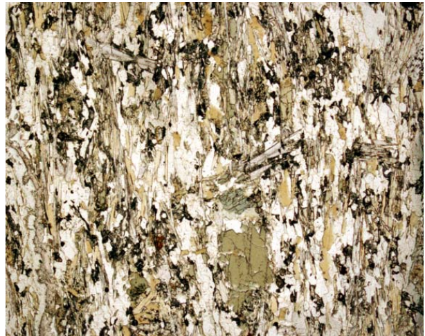
Figura 8.1.5. Metatufita del exocontacto con anfíbol verde, cuarzo, biotita y holmquistita (liláceo pálido). La holmquistita está desorientada. Sin analizador. Campo, 11,6 mm.
