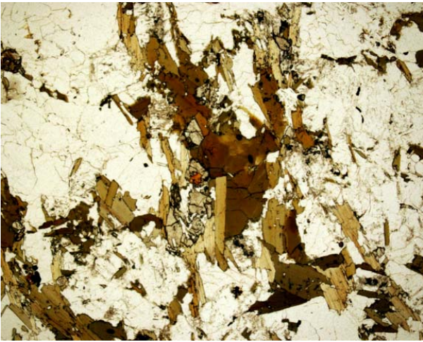
Figura 3.1.67. Otro aspecto de la misma roca, sin analizador, con la epidota asociada a biotita y plagioclasa. Campo, 2,4 mm. Nótese la ausencia de alteración de la biotita y de la
