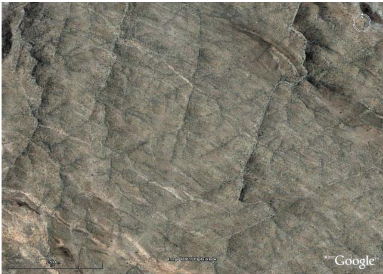
Figura 3.1.127. Red de diaclasado desarrollada en los esquistos precámbricos del NE de la zona; el trazado de las fracturas está muy acentuado por la vegetación arbustiva. Nótese en esta imagen de satélite la existencia de dos sistemas de fracturas conjugados, cada uno de los cuales con un conjunto de diaclasas subparalelas.
