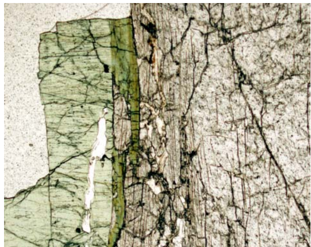
Figura 9.1.31. Elbaita reemplazando espodumena en las vetas equivalentes a la figura 9.1.23. Sin analizador. Campo, 11,6 mm.
