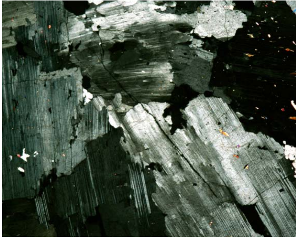
Figura 7.1.16. Placas albíticas de la segunda generación de albita, reemplazantes de feldespato potásico. Nícoles cruzados. Campo, 11,6 mm.
