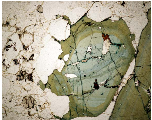
Figura 5.1.16. Cristales esqueléticos de turmalina en intercrecimientos gráficos con cuarzo; se aprecian cristales pequeños de granate. Sin analizador. Campo, 11,6 mm..
