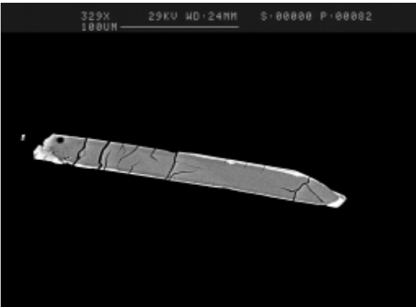
Figura 8.1.78. Cristal de columbita con zonado simple, con borde más rico en Ta. Imagen de microscopio electrónico, modo electrones retrodispersados.
