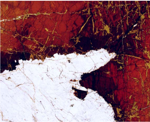
Figura 8.1.65. Cristales de gran tamaño de ferrisicklerita (rojiza) reemplazados en sus bordes por heterosita (oscura); el mineral claro es plagioclasas in analizador. Campo, 11,6 mm.
