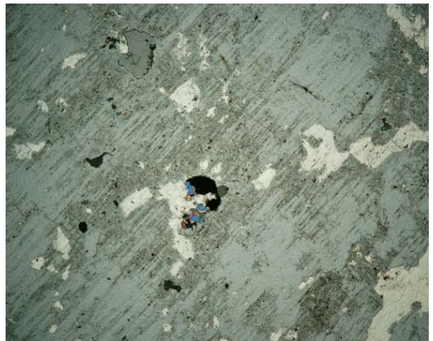
Figura 8.1.108. Cristales de microclina con macropertitas; nótese en algunas zonas la presencia de aspecto turbio (microinclusiones). Nícoles cruzados. Campo, 11,6 mm.
