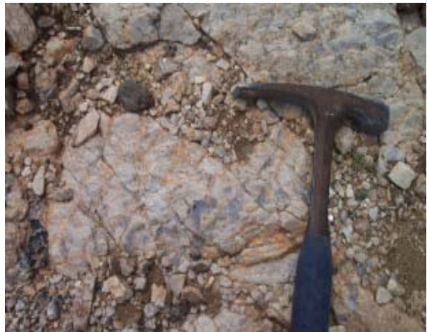
Figura 8.1.14 . Intercrecimientos gráficos de microclina rosácea con cuarzo incoloro en la primera zona intermedia de la pegmatita A.
