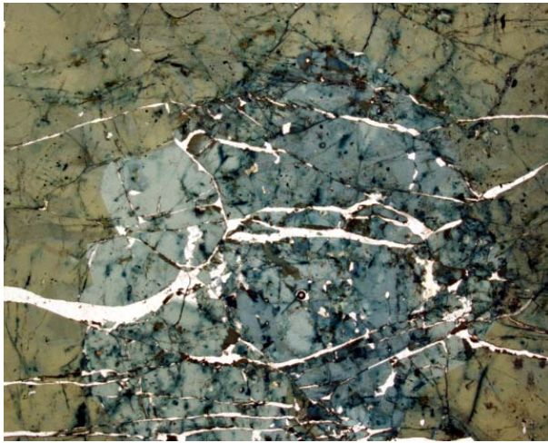
Figura 6.1.50. Cristal de turmalina zonado, con el núcleo azul y la periferia verde oliváceo. Queda cortado por vetas de cuarzo; nótese la turmalina más tardía. Sin analizador. Campo, 11,6 mm.
