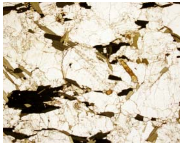
Figura 3.1.20. Detalle al microscopio de luz transmitida (sin analizador) de una anfíbolita, con plagioclasa, anfíbol (verde), biotita (marrón) y allanita zonada (amarillo parduzco). Campo, 5,8 mm.
