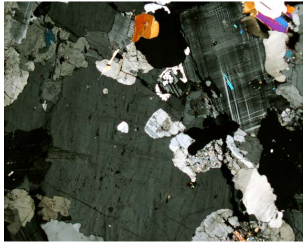
Figura 5.1.7. Microclina no perítica englobando plagioclase en la primera zona intermedia. Nícoles cruzados. Campo, 11,6 mm.
