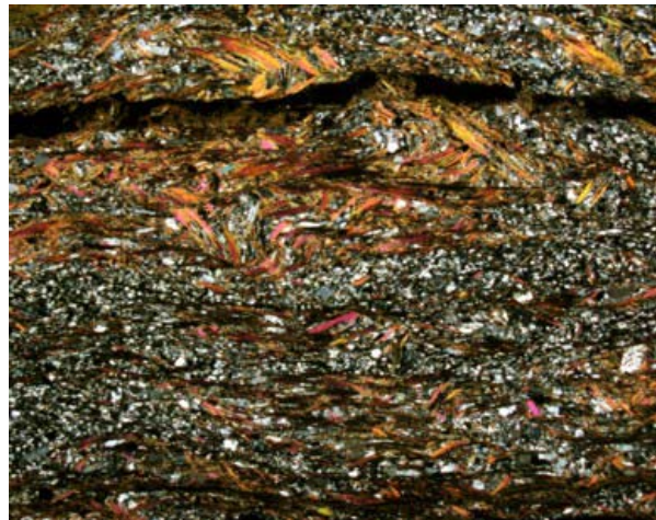
Figura 3.1.14. Esquistosidades transpuestas en materiales metapelíticos, definidas por moscovita; la fase principal está horizontal en la imagen. Nícoles cruzados; campo, 5,8 mm.
