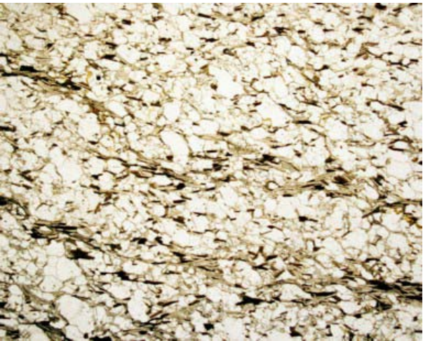
Figura 3.1.29. Detalle al microscopio de luz transmitida (sin analizador) de un esquistosilíceo moscovítico, con cuarzo, biotita y cristales tabulares de moscovita. Campo, 11,6 mm.
