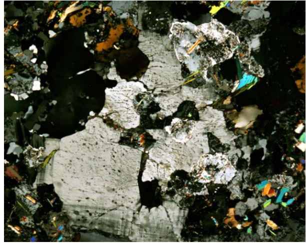
Figura 3.1.79. La imagen anterior en nícoles cruzados; el cristal de microclina (maclada) engloba a plagioclasa zonada; se distinguen algunos cristales de moscovita.
