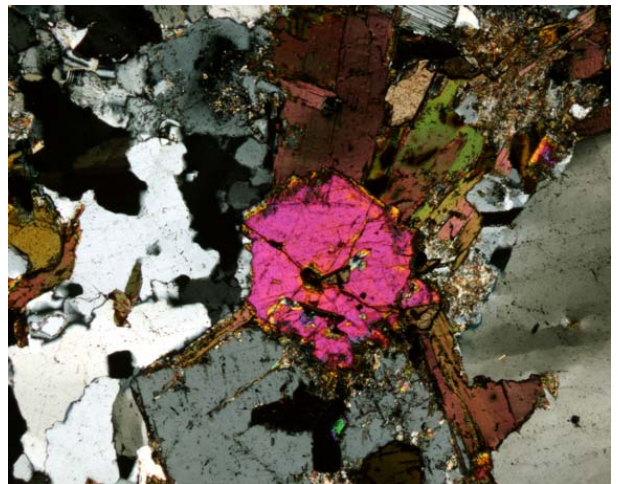
Figura 3.1.64. La muestra anterior en nícoles cruzados; la epidota, idiomórfica, destaca por sus colores de interferencia del tercer orden. La biotita y la plagioclasea no están alteradas.
