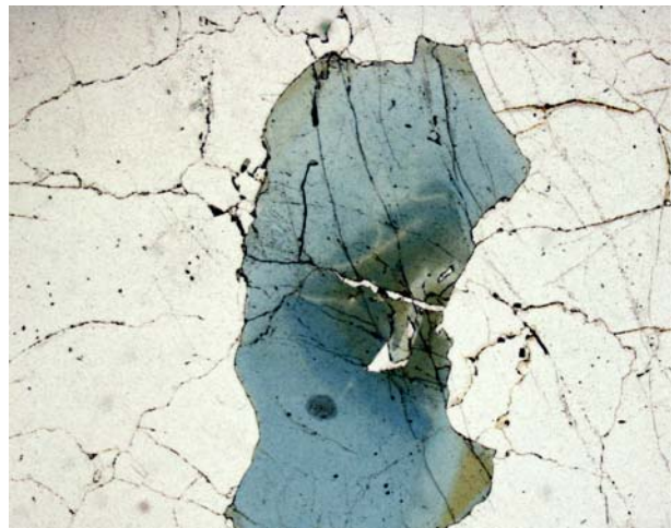
Figura 9.1.18. Zonado de un cristal de turmalina de la primera zona intermedia, incluido en cuarzo. Sin analizador. Campo, 5,8 mm.
