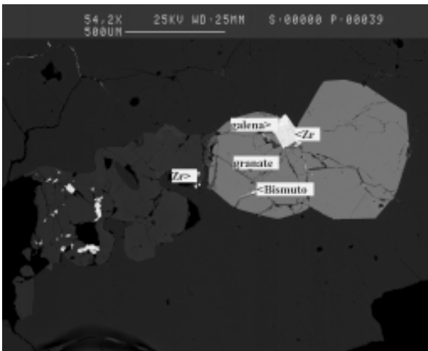
Figura 7.1.38. Cristales de granate asociados a circón (Zr), éste parcialmente reemplazado por galena; el granate tiene vetillas tardías conteniendo bismuto nativo. Imagen de SEM, modo BSE.
