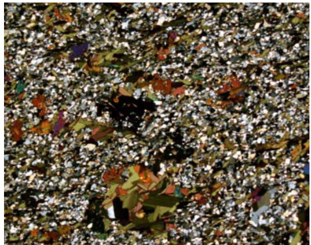
Figura 3.1.26. La imagen anterior, en nícoles cruzados. A remarcar la abundancia de cuarzo y la textura de grano fino.
