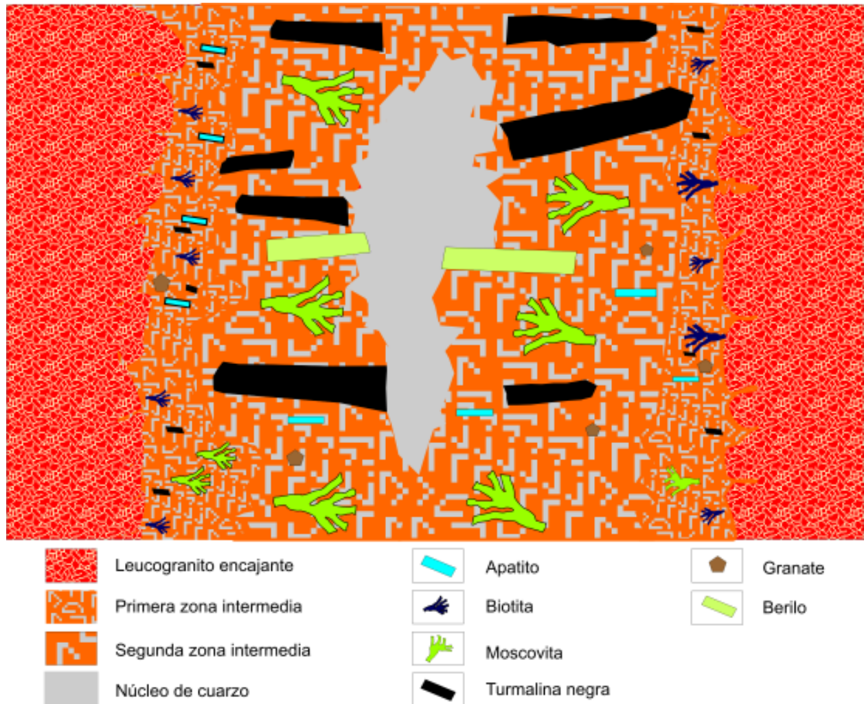
Figura 5.1.5. Esquema conceptual (no a escala) mostrando la estructura idealizada de las pegmatitas de tipo I y la distribución de sus minerales accesorios.
