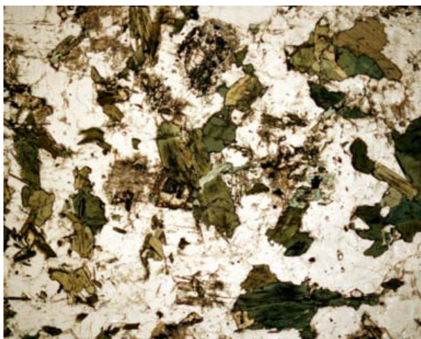
Figura 3.1.56. Detalle al microscopio de luz transmitida (sin analizador) de una cuarzodiorita, con allanita (relieve alto, incolora) en el centro de la imagen. Campo, 5,8 mm.
