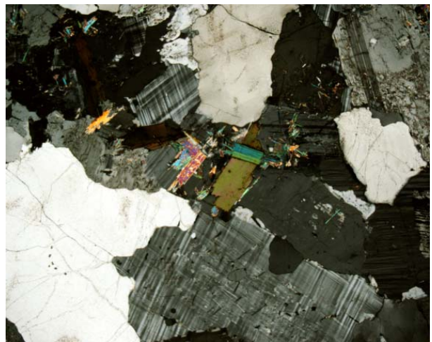
Figura 3.1.101. La imagen anterior en nícoles cruzados. A remarcar el maclado en parrilla de la microclina y el polisintético según la ley de la albíta en la plagioclasa.
