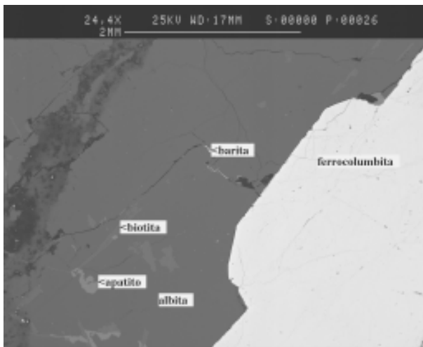
Figura 7.1.40. Veta rellena de barita supergénica cortando feldspatos. Imagen de SEM, modo BSE.
