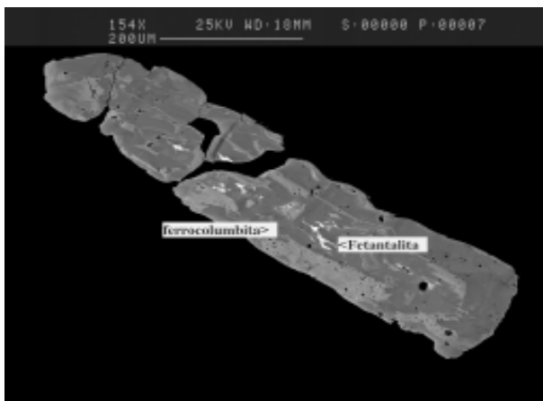
Figura 8.1.84. Cristal de columbita con zonado complejo parcheado, con estadios tardíos más ricos en Ta. Imagen de microscopio electrónico, modo de electrones retrodispersados.
