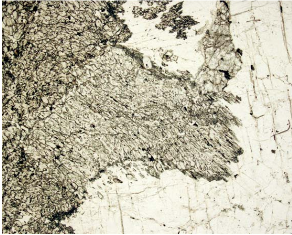
Figura 9.1.24. Simplectitas de espodumena y cuarzo pseudomorfizando petalita. Sin analizador. Campo, 11,6 mm.
