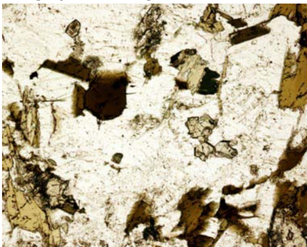
Figura 3.1.65. Otro detalle de la misma roca, si analizador, con algunos cristales de microclina y plagioclasea englobando epidota. Campo, 2,4 mm.
