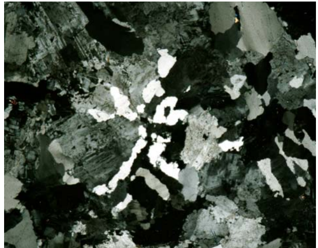
Figura 6.1.30. Cristales de microclina con intercrecimientos gráficos con cuarzo. Nícoles cruzados. Campo, 11,6 mm.
