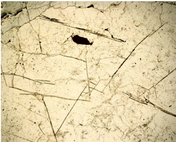
Figura 7.1.24. Cristales de columbita (opaco) asociados a albita de formación tardía que reemplaza feldespatos potásico. Campo, 11,6 mm.
