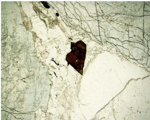
Figura 9.1.50. Veta de cuarzo-moscovita con casiterita (relieve muy alto, oscura) cortando turmalina azulada en la segunda zona intermedia. Sin analizador. Campo, 5,8 mm.
