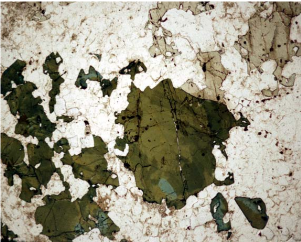
Figura 7.1.4. Cristal esquelético de turmalina zonado, con el núcleo azul y la periferia verde oliváceo. Está intercrecido con cuarzo y albita. Sin analizador. Campo, 11,6 mm.
