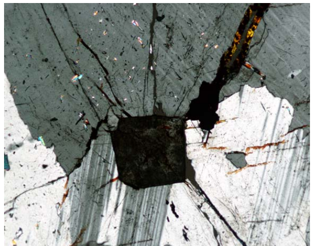
Figura 7.1.14. La imagen anterior, en nícoles cruzados. A destacar el caracter metamíctico del mineral, estando casi isotropizado.
