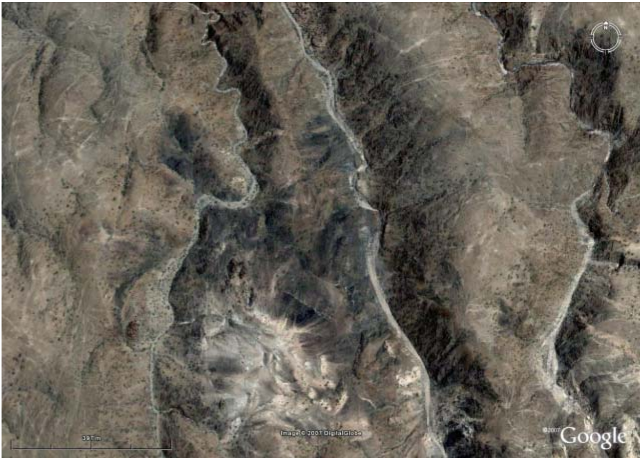
Figura 3.1.45. Imagen de satélite del afloramiento principal de cuerpos ultrabásicos del área (color más oscuro), encajados en esquistos (color grisáceo). Se aprecia, además, algunos diques de pegmatitas, de colores blancuzcos o rosados, emplazados tanto en los cuerpos ultrabásicos como en los esquistos. Sobre uno de ellos se realizaron diversas labores de exploración minera para minerales de elementos raros durante los años 1960.
