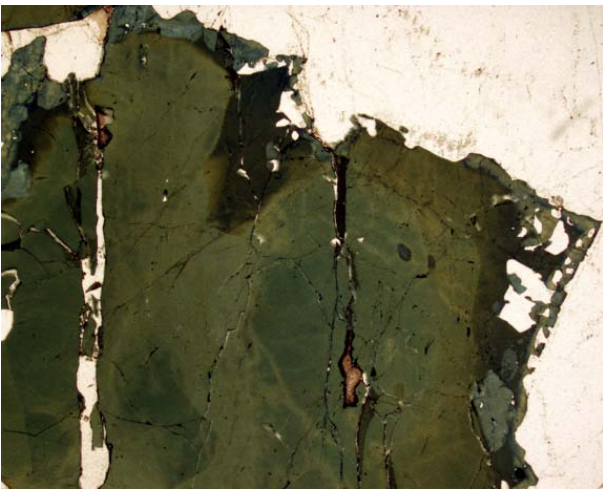
Figura 8.1.31. Zonación longitudinal irregular en un cristal de turmalina, con la turmalina verde concentrándose hacia los bordes y extremos. Sin analizador. Campo, 11,6 mm.
