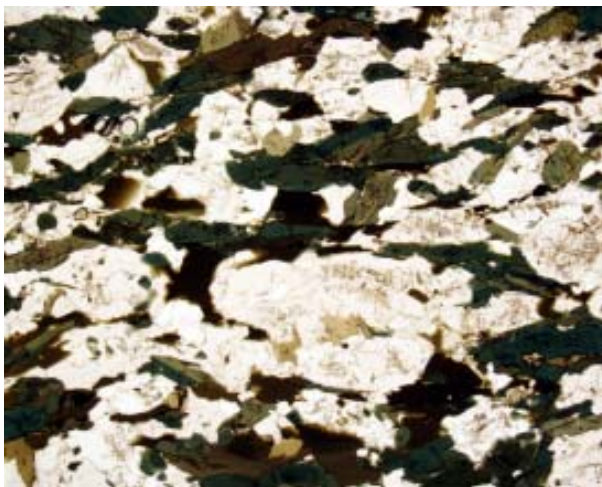
Figura 3.1.19. Detalle al microscopio de luz transmitida (sin analizador) de una anfíbolita, con plagioclasa, anfíbol (verde) y biotita (marrón) . Campo, 5,8 mm.
