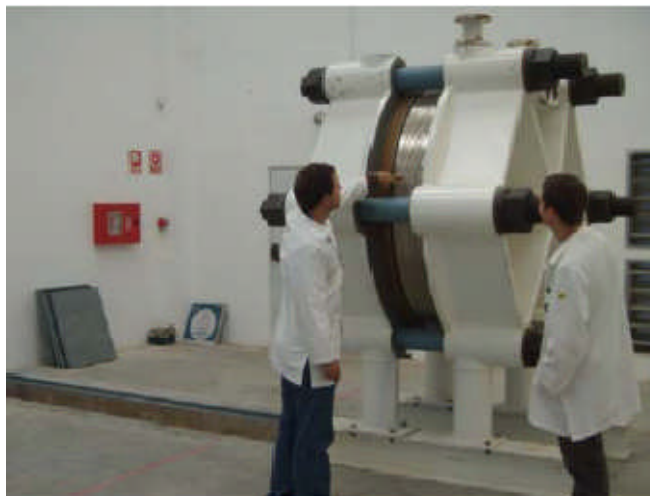
Figura 17- Electrolizador alcalino 50 kW, 10 m 3 N/h H 2 . [8]
