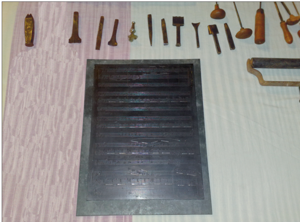
Fig. 6.4b En esta imagen se pueden observar las herramientas utilizadas para el grabado de la plancha: punzones (arriba a la izquierda) y buriles (arriba a la derecha)
