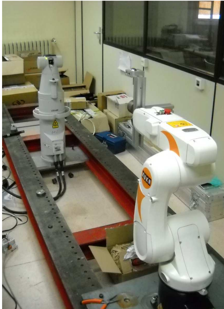
Fig. 6.5 - Montaje laser tracker y robot
