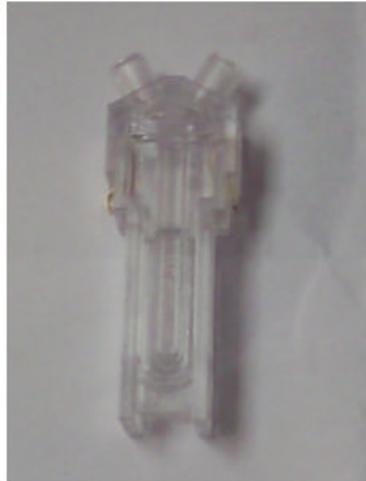
**Fig 35. Celda capilar (plástico)**
