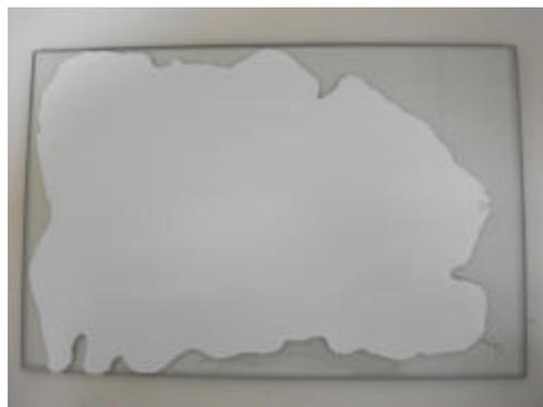
**Fig 51. Lámina colada sobre el cristal sin Mylar.**
