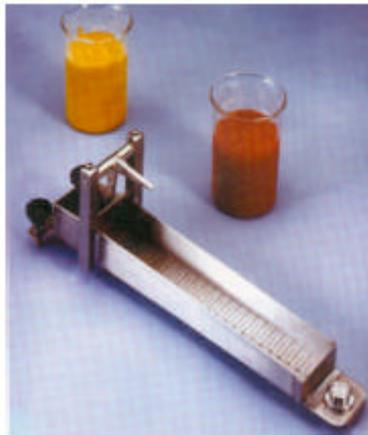
Fig 19. Viscosímetros especiales
