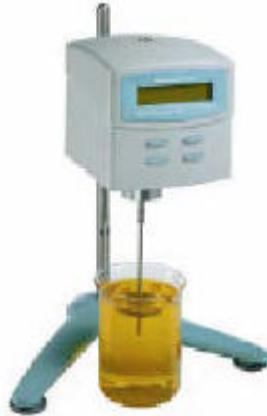
Fig 20. Viscosímetro rotacional relativo.
