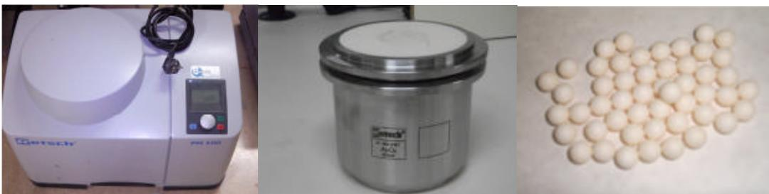
Fig 30. Molino planetario, crisol de alúmina y bolas de alúmina.
