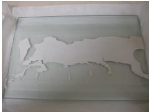
**Fig 50. Lámina colada sobre el Mylar engrasado.**
