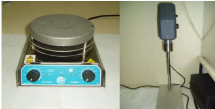
Fig 39. Placa magnética y equipo de ultrasonidos
