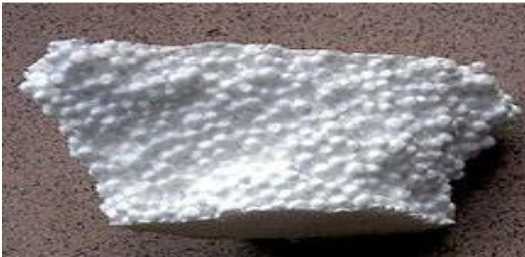
**-Aislamiento:** Realizaremos el aislamiento tèrmico de esa fachada aumentando el espesor del aislante tèrmico, en este caso poliestireno expandido. Con esto conseguiremos que la transmitancia de la fachada norte sea menor y asì, de este modo, en invierno necesitaremos aportar menos calorías consiguiendo minimizar coste y hacer mäs eficiente nuestra vivienda.
