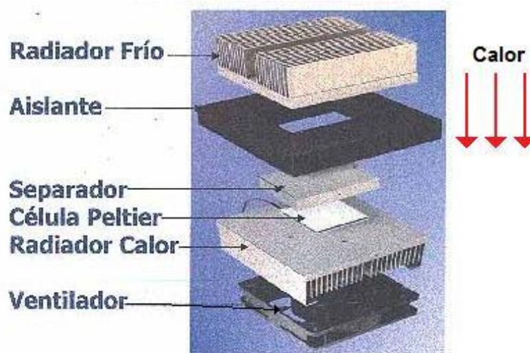
Fig. 6.9 Conjunto termoeléctrico.
