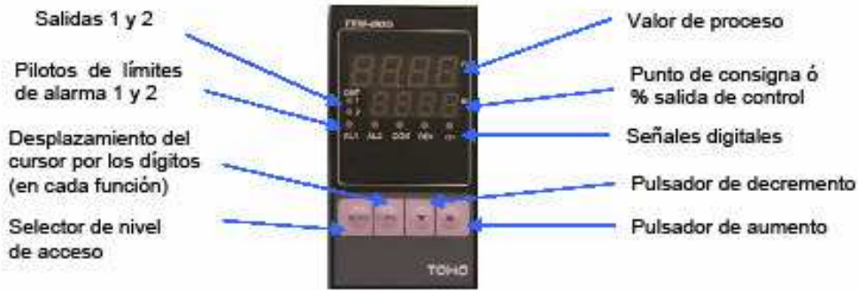
Figura 3.7. Fotografía del controlador de temperatura.
