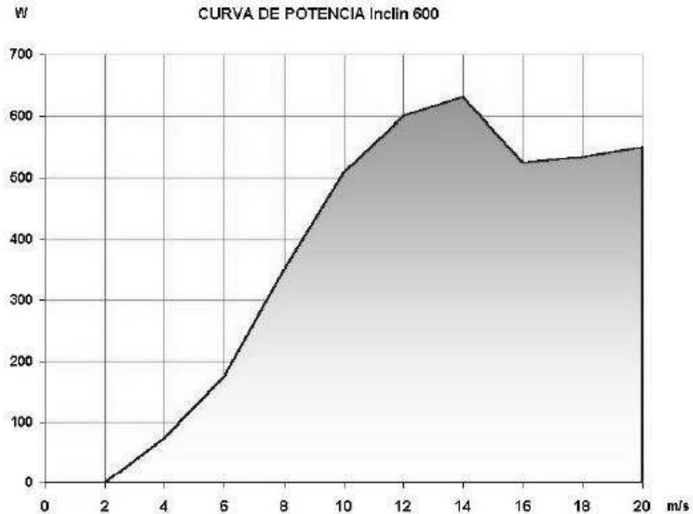
Figura 85.- Potencia aerogenerador en función de la velocidad del viento.
