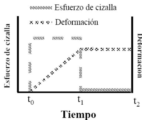
Fig. 4.5 b) Ensayo de fluencia para un líquido newtoniano
