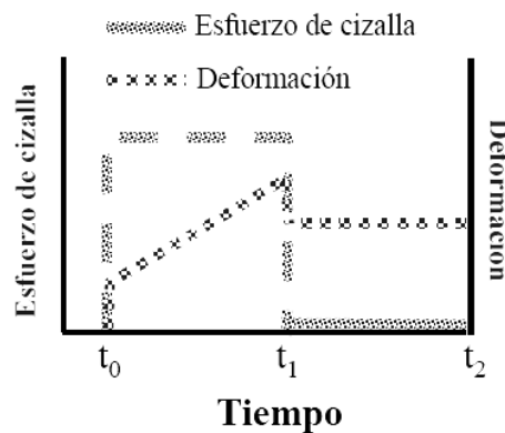
Fig. 4.7 d) Ensayo de fluencia de un fluido de Maxwell
