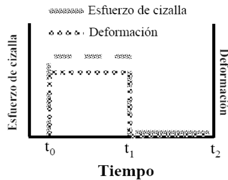
Fig. 4.4 a) Ensayo de fluencia para el sólido de Hooke.
