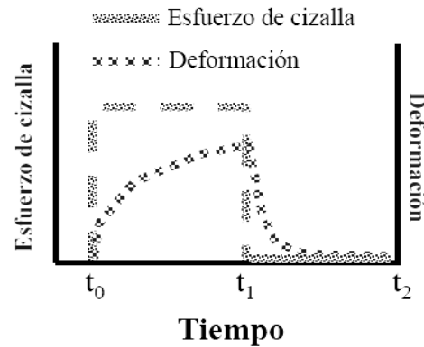
Fig. 4.6 c) Ensayo de fluencia en un sólido de Kelvin – Voigt
