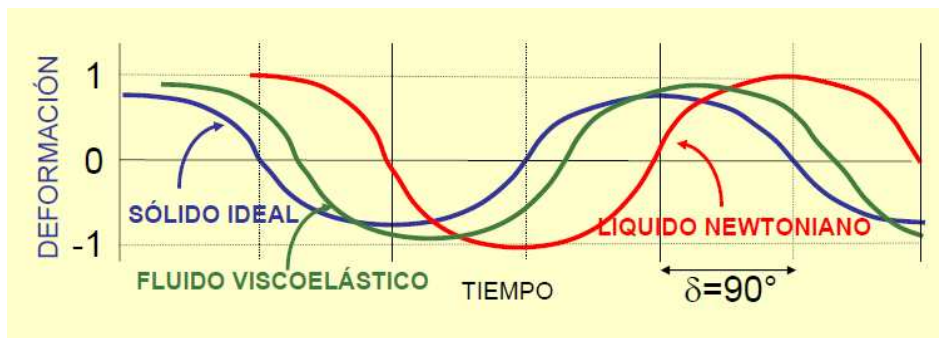
Fig. 4.13 Representación de modelos de sólido elástico, líquido viscoso y material viscoelástico .
