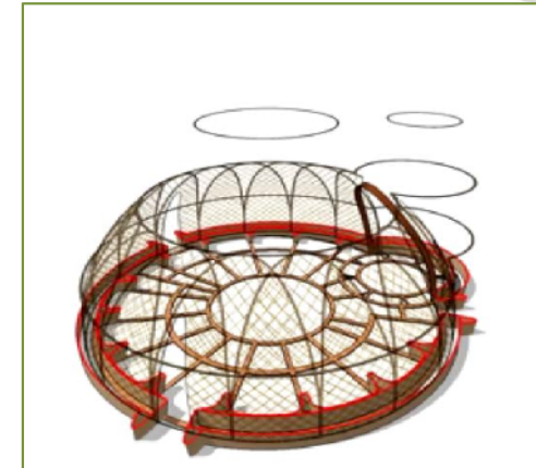
Paso 3: recubrimiento de barro de la parte inferior
