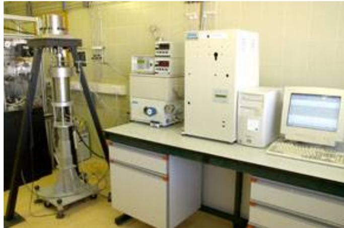
**Figura 21:** Equipo utilizado para TPO
