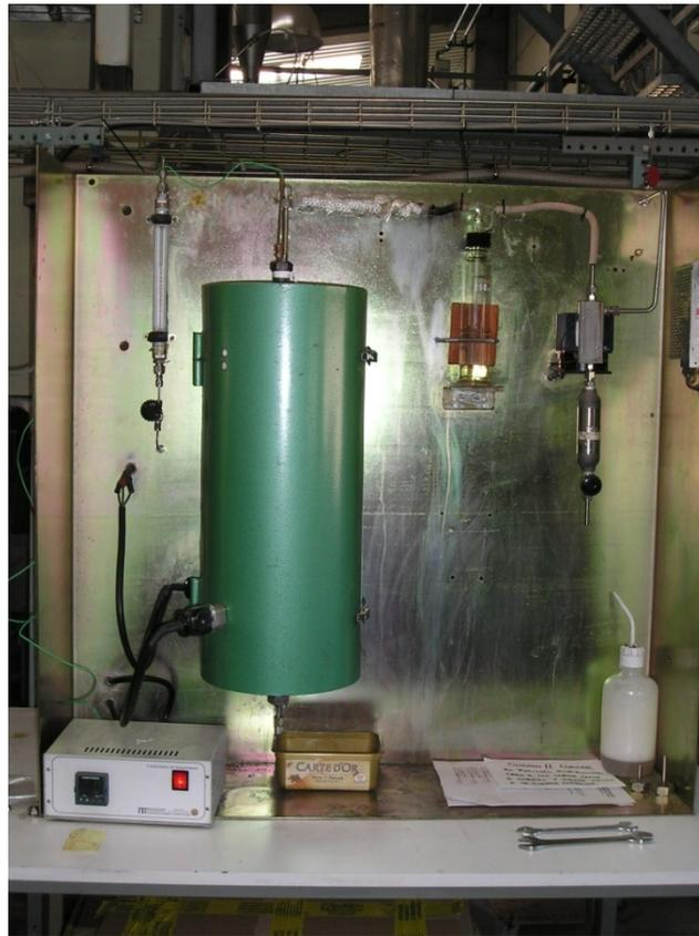
*Figura 16: Planta donde se lleva a cabo la pirólisis.*
