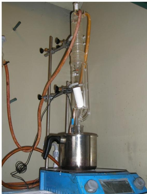
*Figura 17: Montaje soxhlet.*
