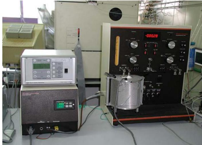
**Figura 20:** *Instalación del equipo de TPD*
