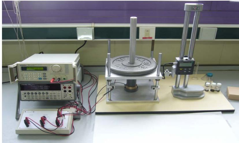
**Figura 23:** Aparato de medida de conductividad eléctrica
