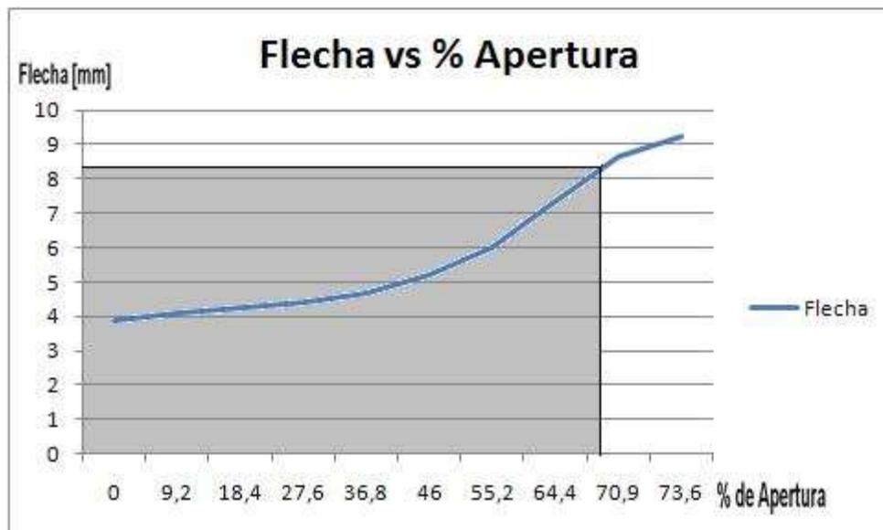
Figura 4.7. Grafica de Flecha vs % de apertura para aperturas en dos laterales.
