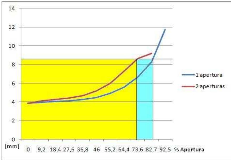
Figura 4.8. Gráfico de Flecha vs % de Apertura.
