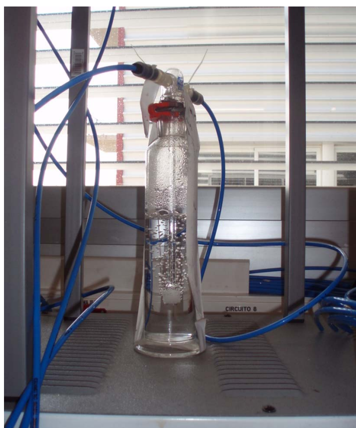
Imagen B.4 Sistema de inyección de agua.
