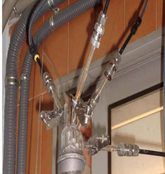
Imagen B.6 Conexiones entre las conducciones y la parte superior del reactor.
