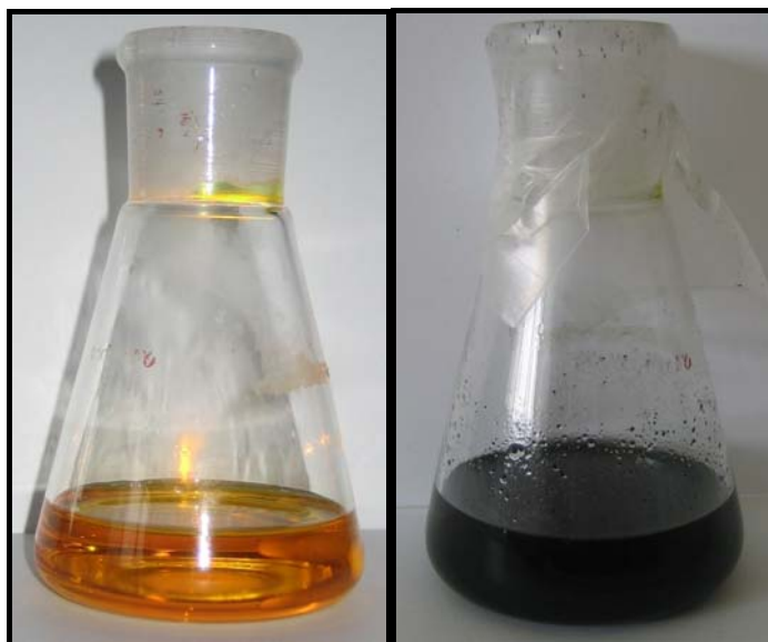
Figura 3-3. Síntesis de catalizadores: Izq. Precursor metálico/EG - Dcha. Adición del Vulcan
