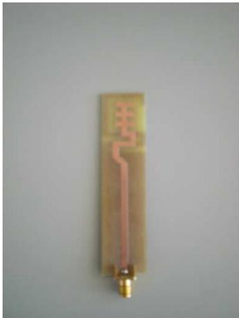
Figura 5.9.- Diseño propuesta 2 banda L
