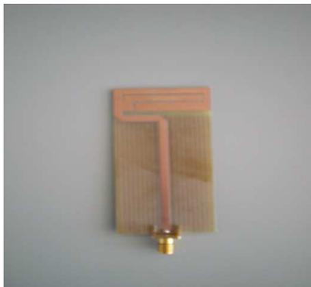
Figura 5.4.- Diseño propuesta 1 banda L
