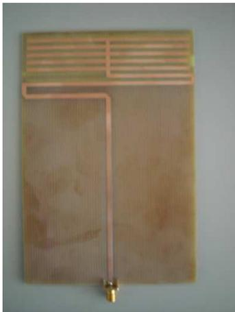
Figura 5.7.- Diseño propuesta 2 banda DVB-H
