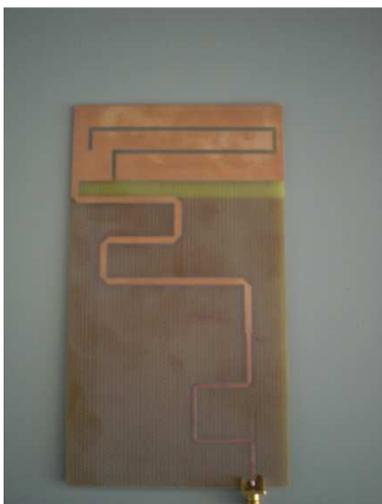
Figura 5.1.- Diseño propuesta 1 banda DVB-H
