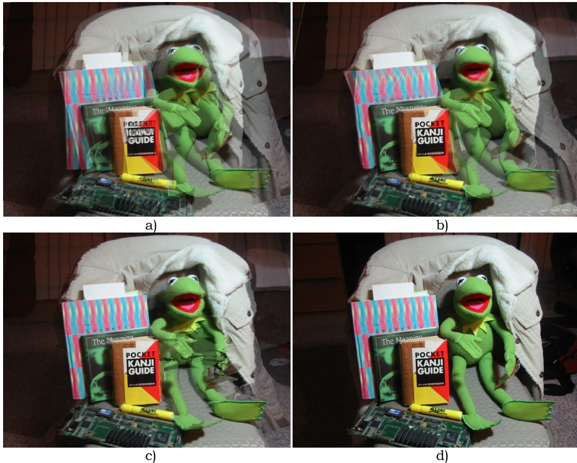
Figura 7.11 a) Método de impostores planares b) Método de triangulación de Delaunay en reconstrucción no densa c) Método de triangulación de Delaunay en reconstrucción densa d) Imagen original
