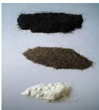
Figura III. 3 De arriba abajo, catalizador Pt-Sn/MgAl 2 O 4 coquizado, catalizador envejecido y catalizador fresco.
