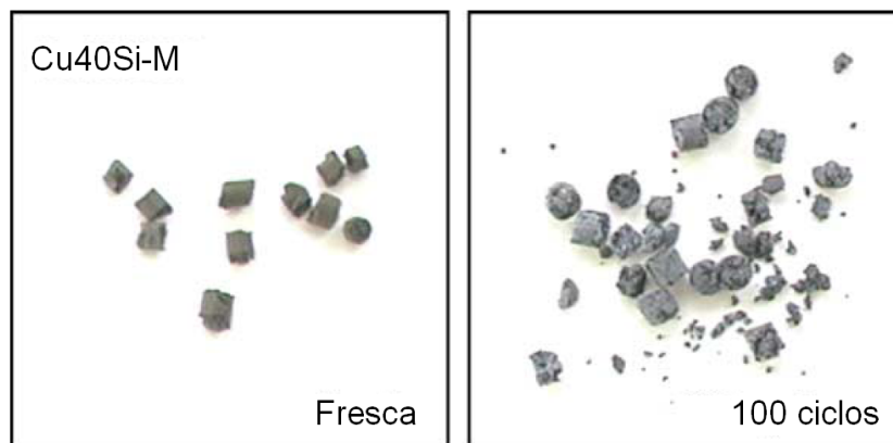
Figura 2.1 Partículas de transportador Cu 40 Si-M antes y después de ciclos redox. Cu 40 Si-M: 40%wtCuO con 60%wt SiO 2 preparado por mezcla mecánica.
