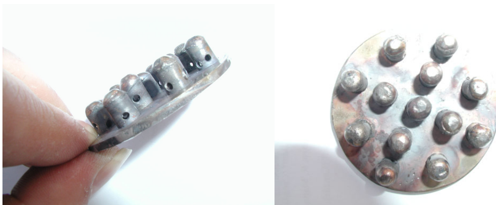
Figura 2.24. Base de campanas del lecho fluidizado.
