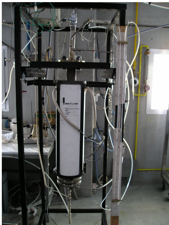
Figura 2.23. Reactor de lecho fluidizado discontinuo.
