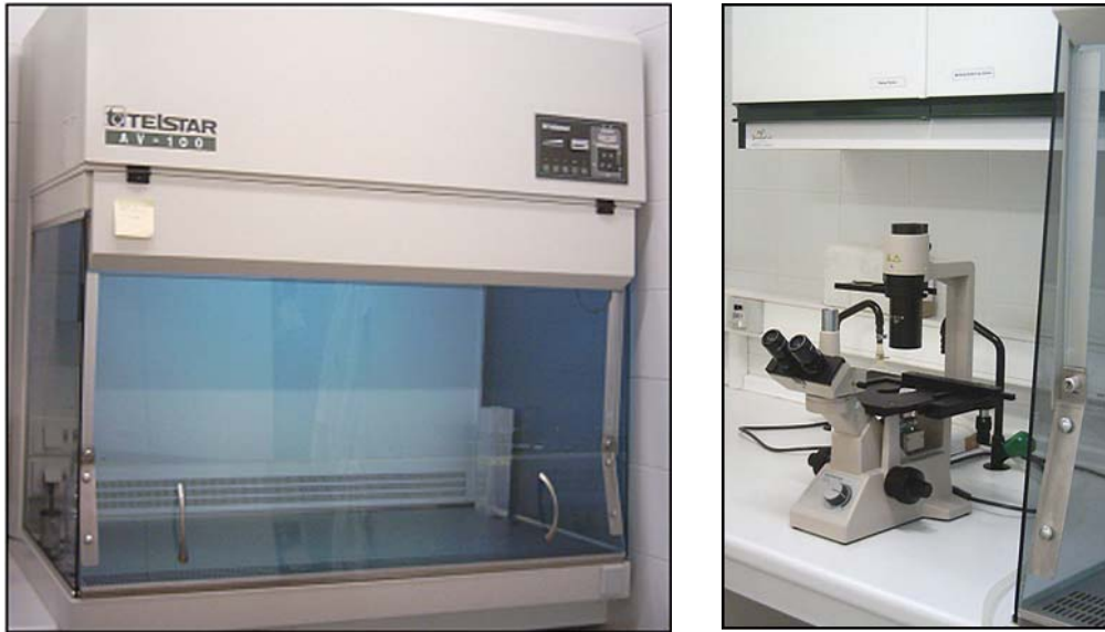
Figura 7. Fotografías de la cabina de flujo laminar (izda.) y del microscopio de luz invertida (dcha.) utilizados para la manipulación y el examen visual de las células respectivamente.
