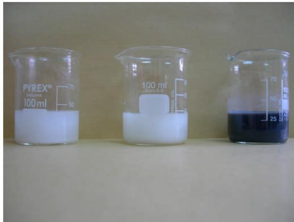
Figura 2-1. Geles, de izquierda a derecha, de Zr-umb, Sn-umb y Ti-umb.
