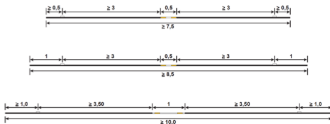
Figur 14 Tvärprofiler mitträffling befintlig väg (Statens vegvesen 2015)
