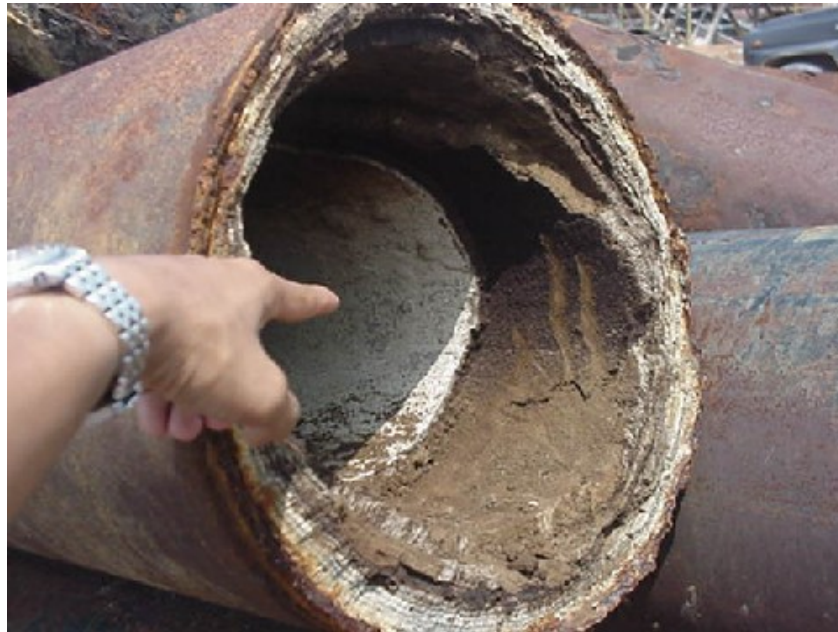
Gambar 3. Pengendapan NORM dalam bentuk kerak air ( scale ) di dalam pipa
