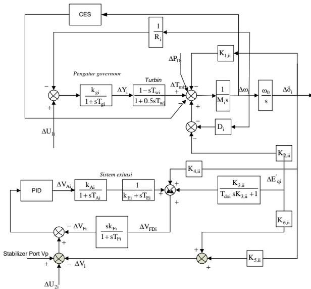
Gambar 5. Test Sistem yang dipasang kontroler PID dan CES
