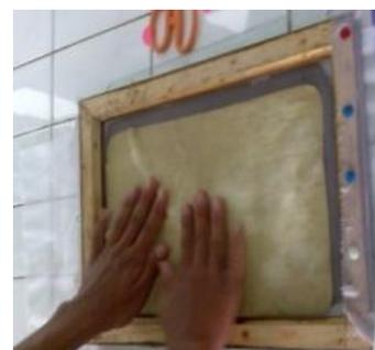
Gambar 5. Proses Pencetakan *Pulp* Kulit Pisang Kepok
