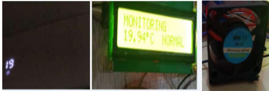
Gambar 9 Data Hasil Pngujian Sensor DS18B20 Pada Sistem Automation Penampilan Nilai Suhu LCD Dan Kipas pada ruangan dingin
