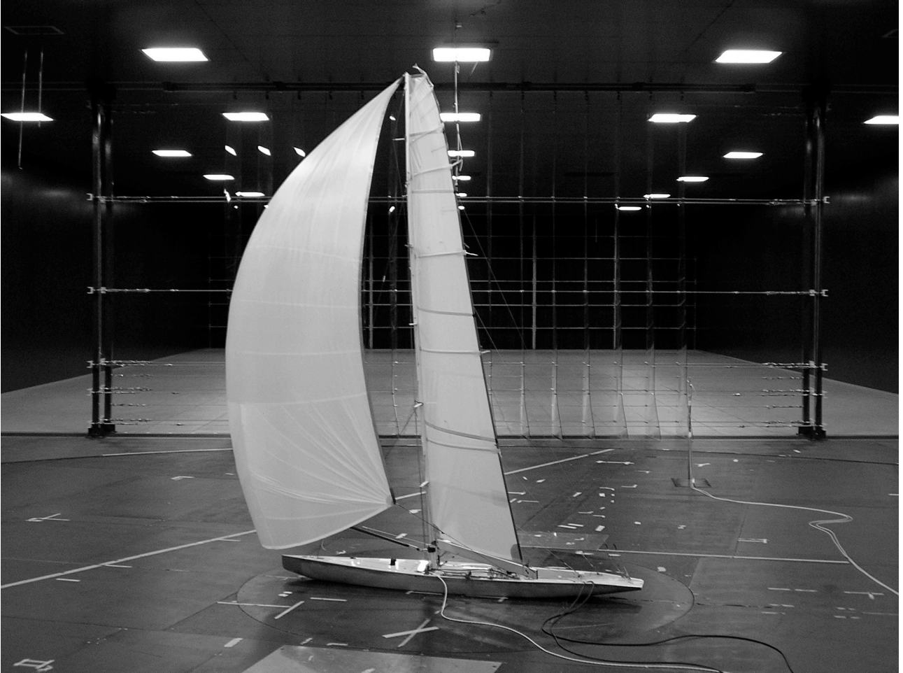
Figura 1. Immagine fotografica di una prova sperimentale nella galleria del vento del Politecnico di Milano.
